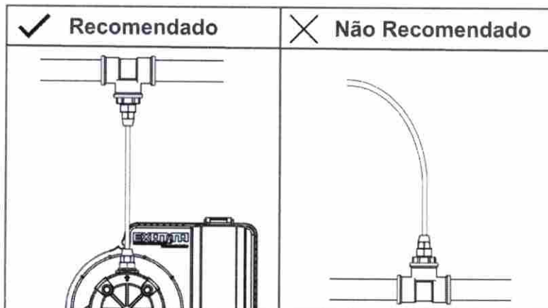
Figura 6: Conexão da válvula de injeção.
